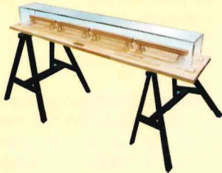
Modell des Besselschen Basismessapparates im Maßstab 1 : 10, zu besichtigen im Haus des Punktes Quersa der Großenhainer Grundlinie.
